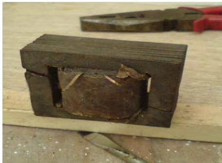
图 2.8 敲击最外层铁心
