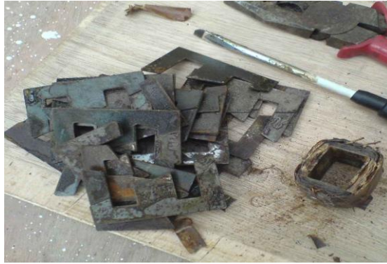
图 2.13 铁心和线圈完全脱离
