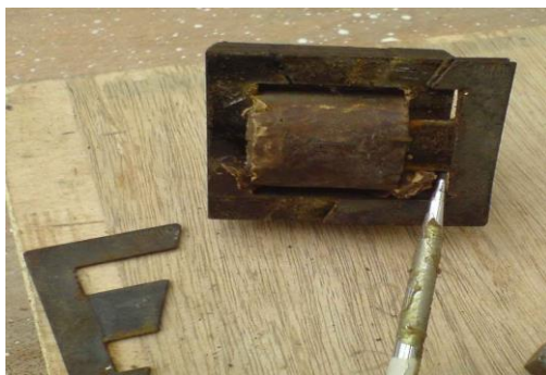
图 2.10 使最外层铁心脱离
