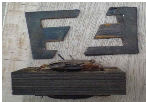
图 2.11 敲出最外层几片铁心
